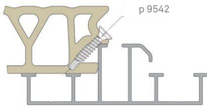
Vorbohrung 3 mm
